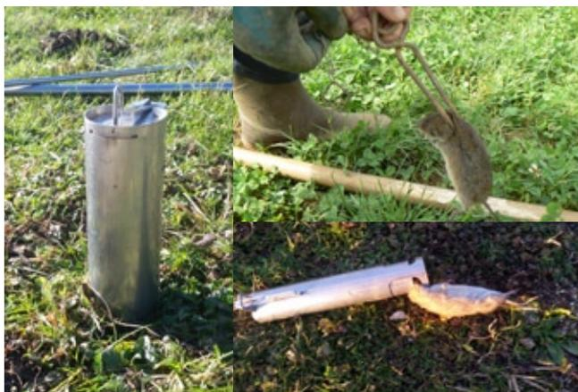
A gauche : piège Topcat installé rapidement à l'aide d'une tarière et d'une sonde.
