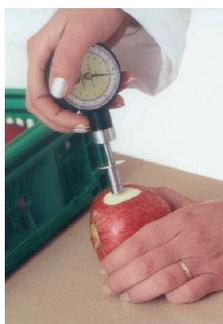
Utilisation d'un pénétromètre
