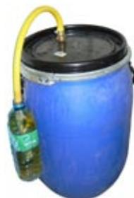
*Comme pour la fermentation de fruits à distiller, il est recommandé d'utiliser un fût équipé d'une bonde de fermentation (ou d'un tuyau plongeant dans de l'eau) pour réaliser la fermentation des plantes.*
