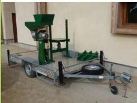
Après 6 années de fonctionnement, l'atelier mobile nécessitait une rénovation importante. Sous l'impulsion de nos formidables adhérents, le plancher bois a été remplacé par des tôles d'aluminium, le moteur du broyeur révisé et quelques retouches de peinture effectuées. Merci à eux !
